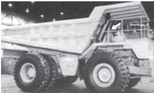
شکل ۳۰-۶- محل مخزن روغن سیستم فرمان
