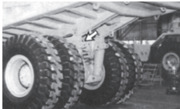
شکل ۴۸-۶ آزمایش زنگ خطر دنده عقب
