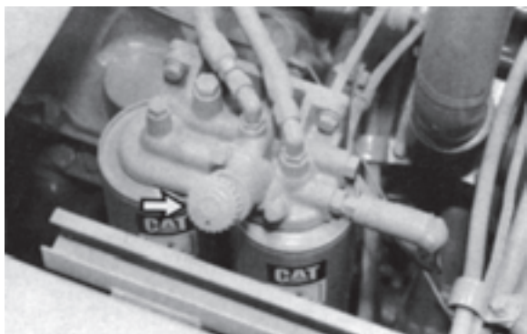
شکل ۷۰-۶- هواگیری سیستم سوخت
