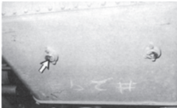
شکل ۶-۱۸- پیچ تخلیه مخزن هیدرولیک
