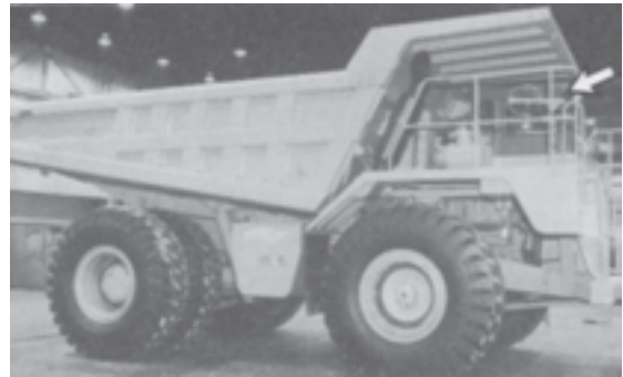
شکل ۳۷-۶- بررسی وضعیت اسکلت اتاق راننده
