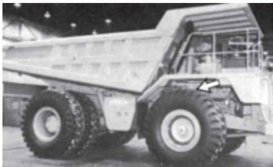
شکل ۳۶-۶- بررسی وضعیت سیلندرهای تعلیق، شارژ سیلندرها
