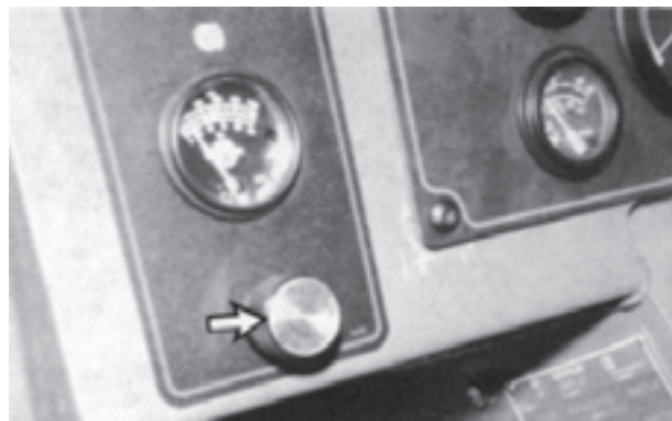
شکل ۴۴-۶- کنترل تمام چراغ‌های ماشین
