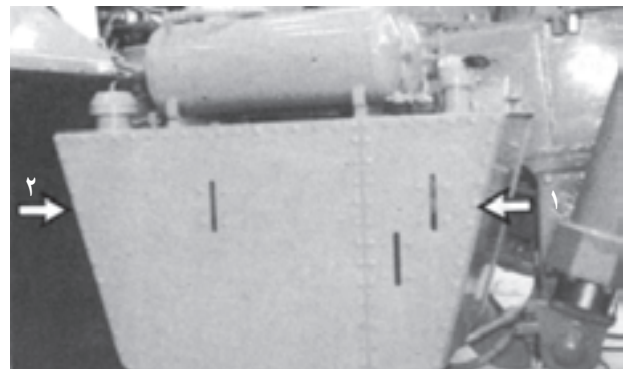
شکل ۲۹-۶- مخزن روغن هیدرولیک
