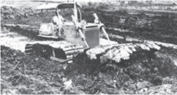
شکل ۴-۵- بولدوزر نوع چرخ زنجیری
