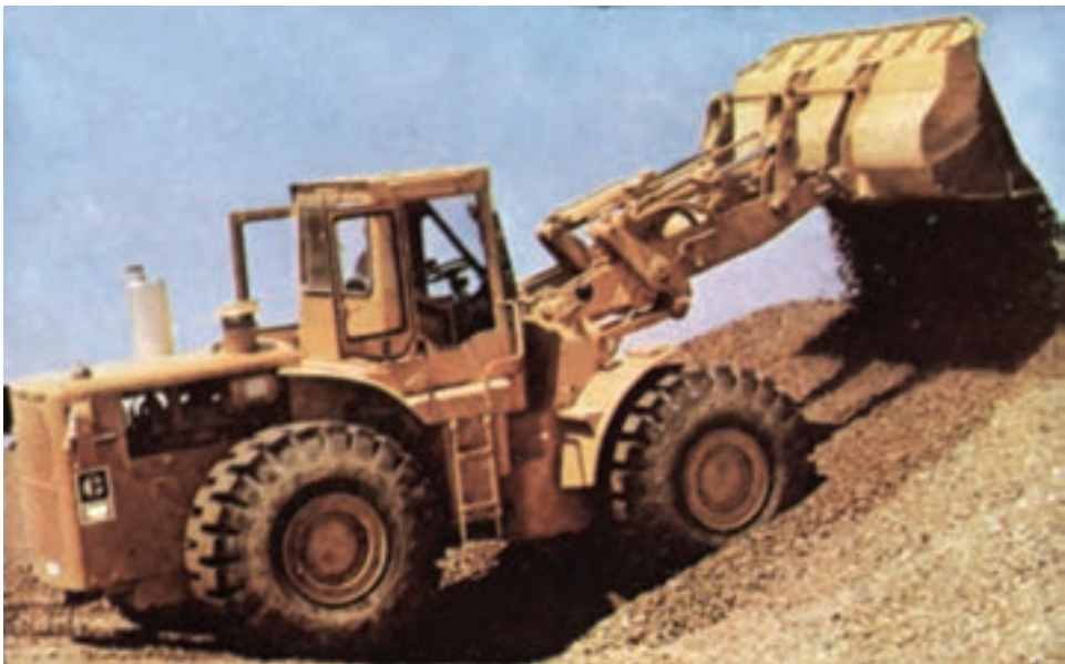
شکل ۱۳-۴- خاک برداری به وسیله لودر
