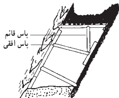
شکل ۴۶-۲۴- نحوه‌ی قرار دادن پاس‌های افقی زیر پاس‌های قائم
