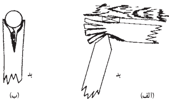
الف - باریک کردن بیش از حد ستون ب - نامساوی بودن شعاع کلاهدک با شعاع قوسی ستون
