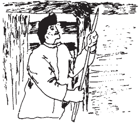
شکل ۳-۱۷- بازرسی سقف و داربست از طریق صدا
