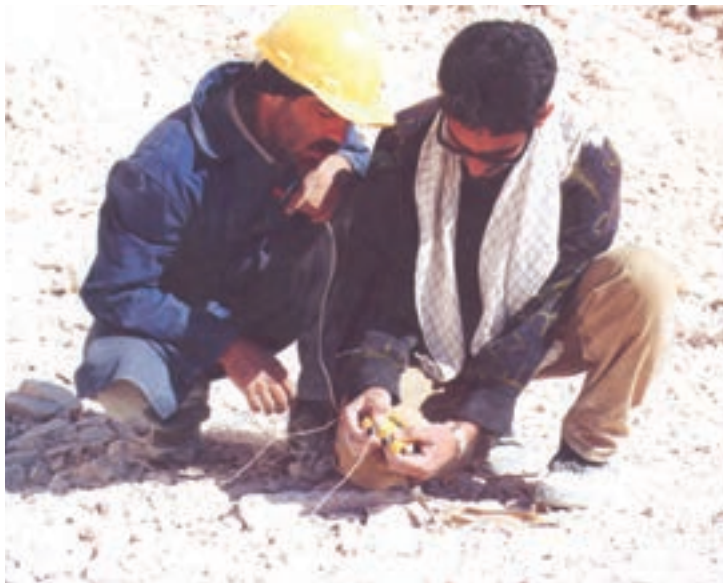
شکل ۱۲- ۱۶- نحوه‌ی کارکردن با اهم متر
