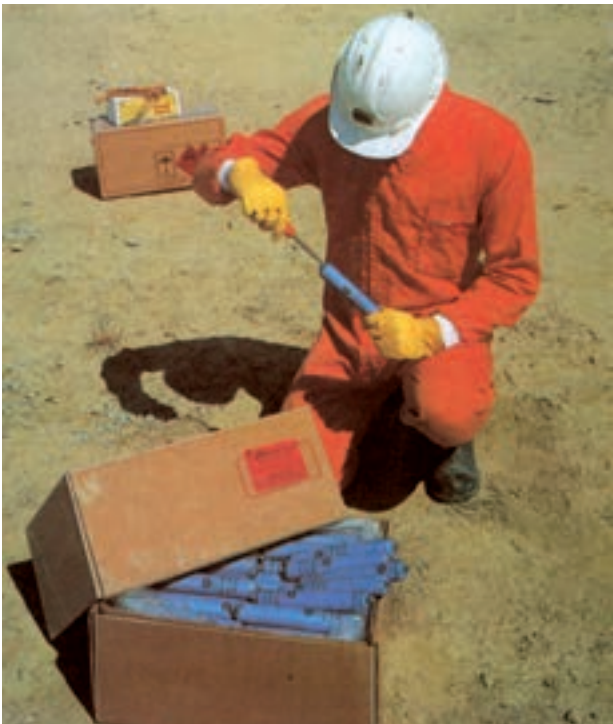
شکل ۹-۱۶- نحوه سوراخ نمودن دینامیت با درفش
