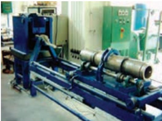
شکل ۱۳-۷- نوع دیگری از ماشین گریز از مرکز افقی
