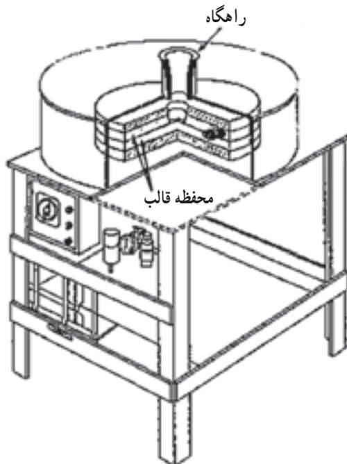
شکل ۱۵-۷ - ماشین ریخته‌گری نیمه‌گریز از مرکز عمودی
