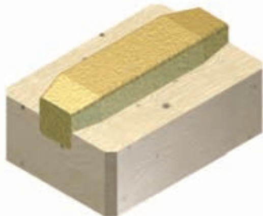
شکل ۵-۲۳- قالب گیری ماهیچه (نیمی از ماهیچه)
