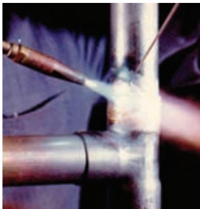
شکل ۱۸-۱- تکنیک جوشکاری به روش اکسی استیلن
