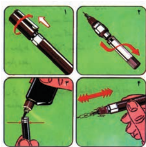
شکل ۲-۲- نحوه پرکردن قلم رایپد
