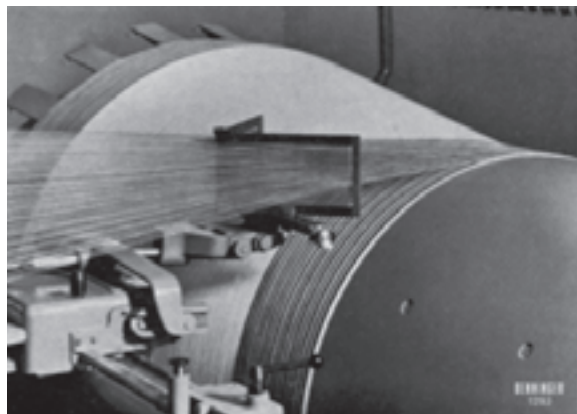
شکل ۴-۲- ساپورت ماشین چله‌پیچ بخشی
