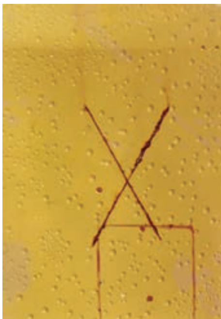
شکل ۱-۶- تاول‌زدگی (عدم مقاومت فیلم در محیط رطوبتی)
