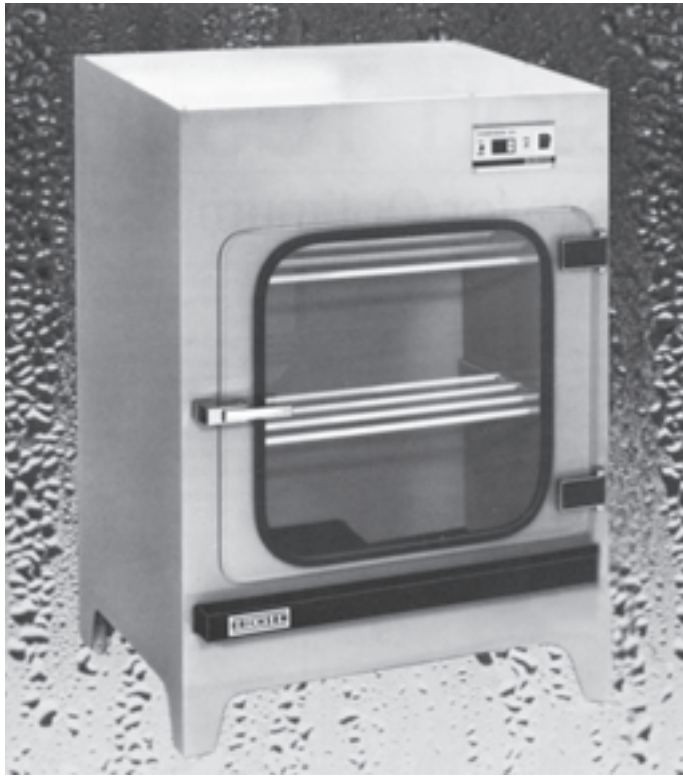
شکل ۲-۱۳- دستگاه تولید رطوبت صد درصد (Humidity) مورد استفاده: بررسی مقاومت فیلم خشک رنگ در محیط‌های مرطوب
