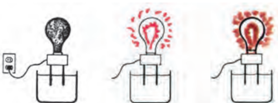
محلول ۰/۲ مولار هیدروکلریک اسید محلول ۰/۲ مولار استیک اسید محلول ۰/۲ مولار شکر چراغ پر نور چراغ کم نور چراغ خاموش (غیر الکترولیت)
