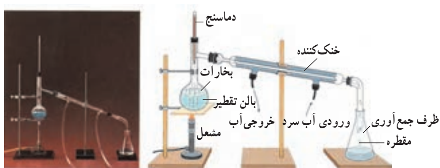
شکل ۱-۵ نمایشی از دستگاه تقطیر آزمایشگاهی
