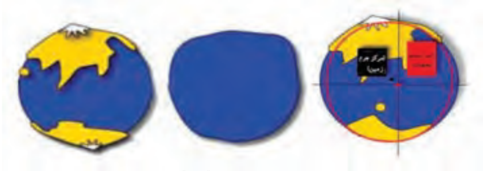
شکل ۳-۴- شکل طبیعی سطح زمین (چپ)، سطح متوسط آبهای آزاد یا ژئوئید به عنوان سطح مبنای ارتفاعی (وسط)، و بیضوی دورانی به عنوان سطح مبنای مسطحاتی (راست)
