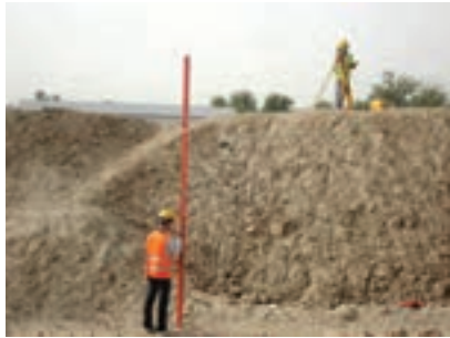
▲ شکل ۱-۶ برداشت به روش تاکنومتری با دوربین ترازباب دیجیتال
