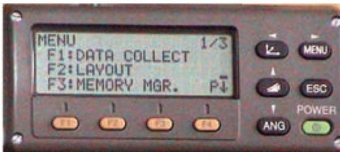
▲ شکل ۶-۱۴- ورود به منوی DATA COLLECT
