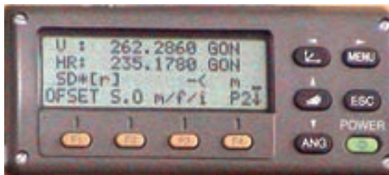
▲ شکل ۶-۹- صفحه دوم منوی طول‌یابی در توتال استیشن تاپکن سری GTS-۲۲۰
