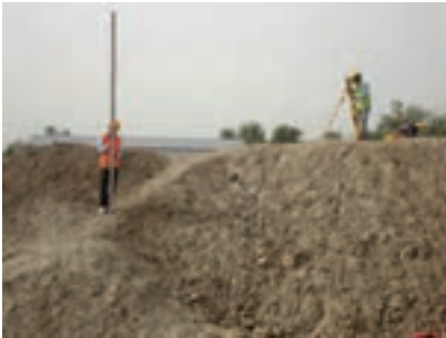
▲ شکل ۱-۶ برداشت به روش تاکنومتری با دوربین ترازباب دیجیتال
