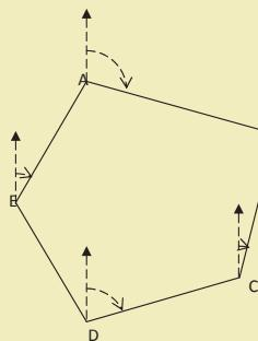
مطابق شکل زیر، یک پنج ضلعی به اضلاع حدود ۵۰ متری در محوطه‌ی هرستان و یا اطراف آن انتخاب کرده و پس از میخ کوبی نقاط رأس آن، با استفاده از قطب‌نما، آزیموت مغناطیسی کلیه‌ی اضلاع این پنج ضلعی را اندازه‌گیری کنید.
