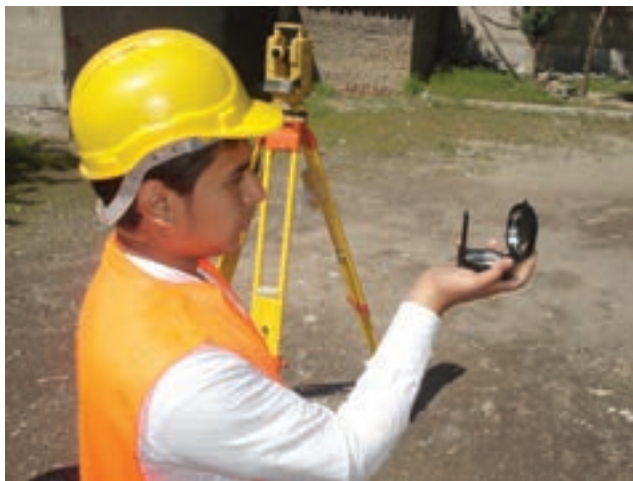
▲ شکل ۴-۲- اندازه‌گیری آزیموت رئوس چندضلعی به کمک قطب‌نما
