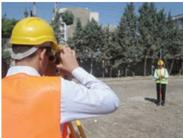
▲ شکل ۴-۳- برداشت زاویه و ژیزمان یک امتداد
