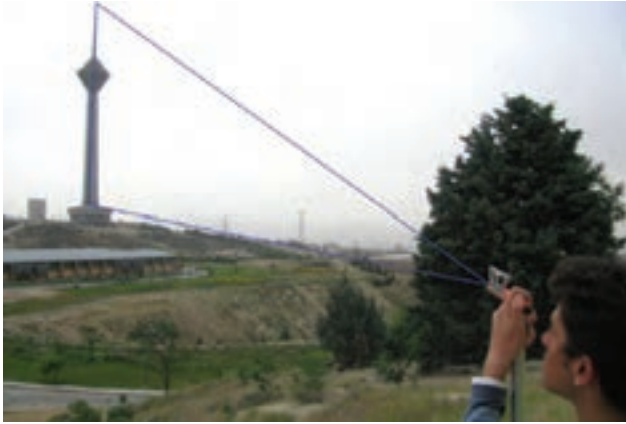
شکل ۶ - ۱۰ . کاربرد شیب سنج در اندازه گیری زاویه ی شیب
