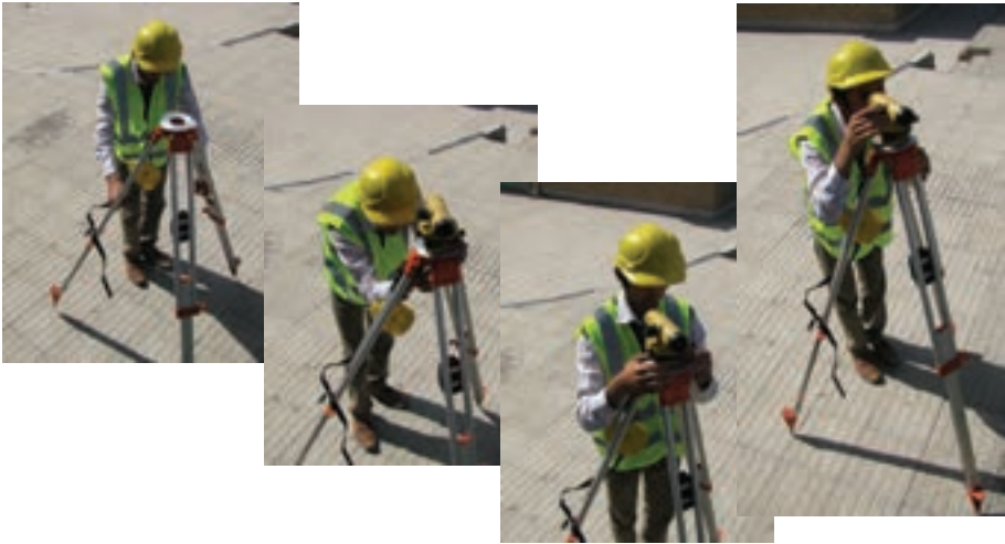
شکل ۱۱ - ۷. مراحل استقرار دوربین تراز یاب
