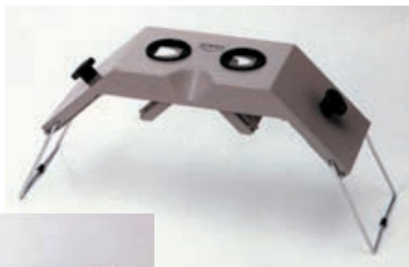
شکل ۳-۹- الف - استروسکوپ آینه‌دار
