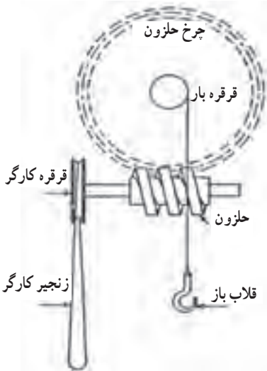
شکل ۲۱-۵- میله حلزون و چرخ حلزون بالابر
