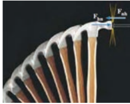
شکل ۲-۳ الف - نیرویی که بین میخ و چکش است. شکل ۳-۲ ب - قانون سوم را در تیراندازی توضیح دهید.
