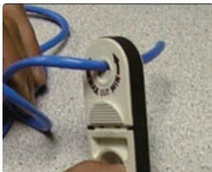
شکل ۴۴-۴- روکش برداری از کابل شبکه
