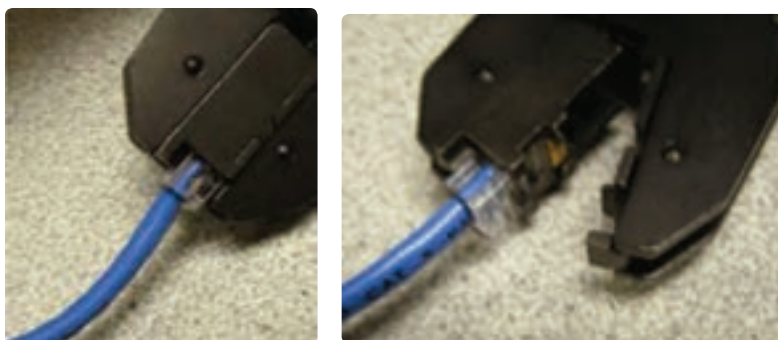
شکل ۴۷- پرس سوکت های کابل شبکه
