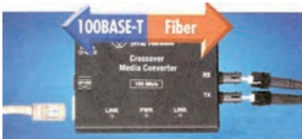
شکل ۱۷-۴- مبدل فیبر نوری به سوکت RJ45
