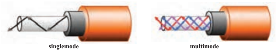
شکل ۱۱-۴- فیبر تک حالت و چند حالت
