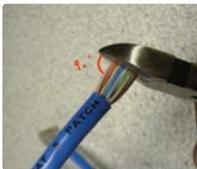
شکل ۴۵-۴- برش سیم‌های کابل شبکه
