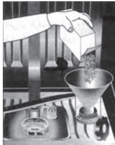
شکل ۹-۱۶- طریقه ریختن نمک در ماشین ظرفشویی اتوماتیک
