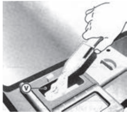
شکل ۱۶-۱۶- ریختن پودر در جابودری اصلی
