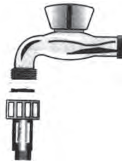
شکل ۷-۱۶- اتصال سر شیلنگ ظرفشویی به شیر آب سرد
