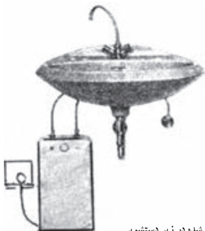
شکل ۲-۵- آبگرمکن نصب شده در زیر دستشویی
