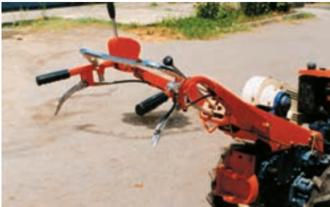
شکل ۵-۹- دسته فرمان تراکتور دوچرخ
