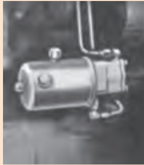
شکل ۲-۱۰- صافی پمپ فرمان در تراکتور MF۲۸۵
