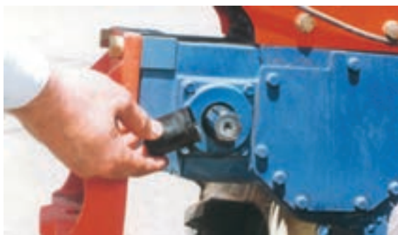
شکل ۹-۳- محور انتقال نیرو و درپوش روی آن
