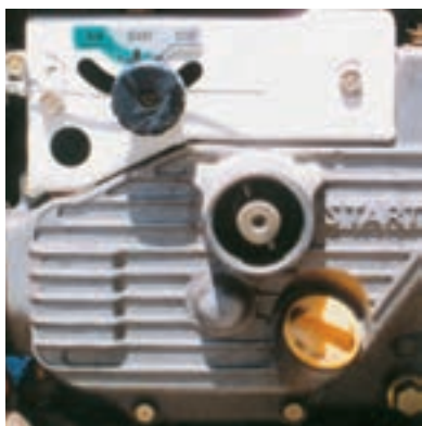
شکل ۹-۱۴- اهرم گاز در حالت استارت
