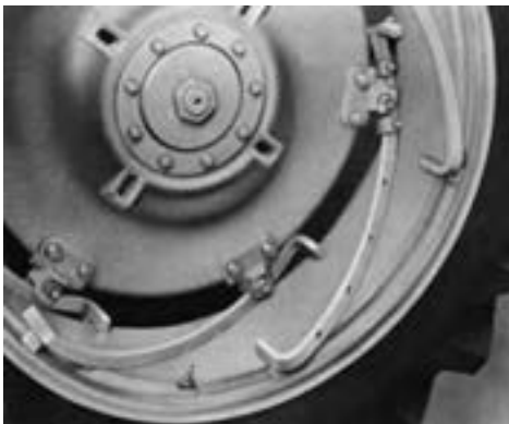
شکل ۱۳ - ۸ - اتصال دیسک به رینگ روی ریل
