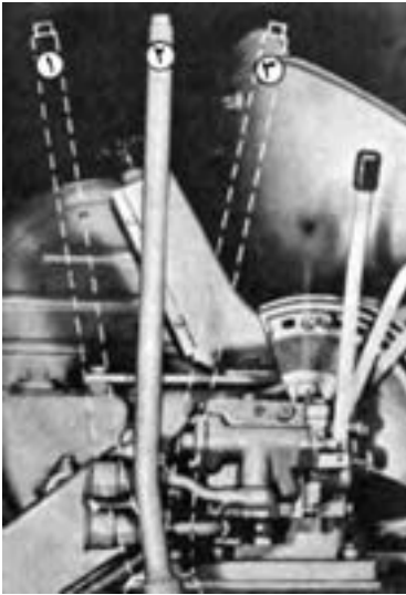
۱- ترمز ۲- خلاص ۳- درگیر شکل ۳-۷- اهرم سه وضعیتی محور انتقال نیرو در تراکتور U 65° M
