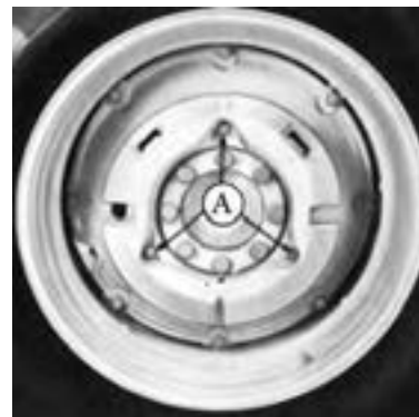
شکل ۱۹-۸- وزنه اول در چرخ عقب تراکتور JD 314 o با سه پیچ (A) به چرخ بسته می‌شود.
