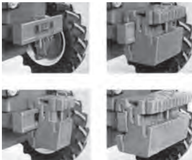
شکل ۲۲-۸- وزنه‌های جلوی تراکتور JD ۳۱۴°
