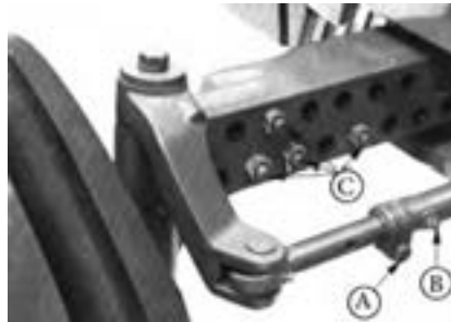
شکل ۱۶-۸- محور جلوی تراکتور JD ۳۱۴۰
