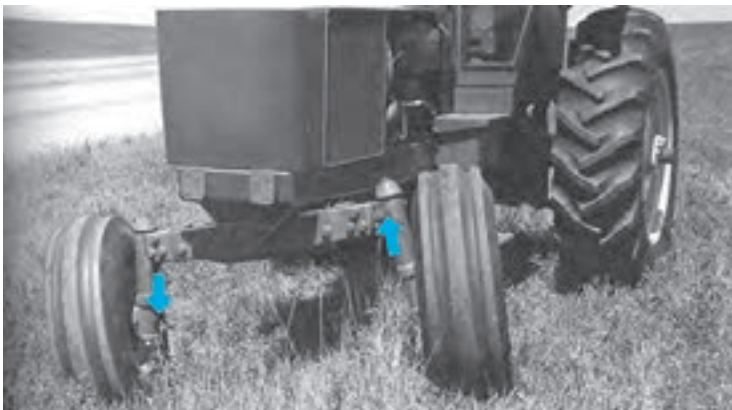
شکل ۳-۲- حالت الاکلنگی محور جلو در تراکتورهای چهارچرخ
