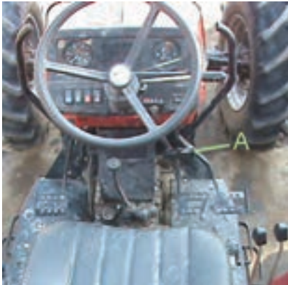
شکل ۲-۱- جفت کن پدال ترمز در تراکتور MF399
