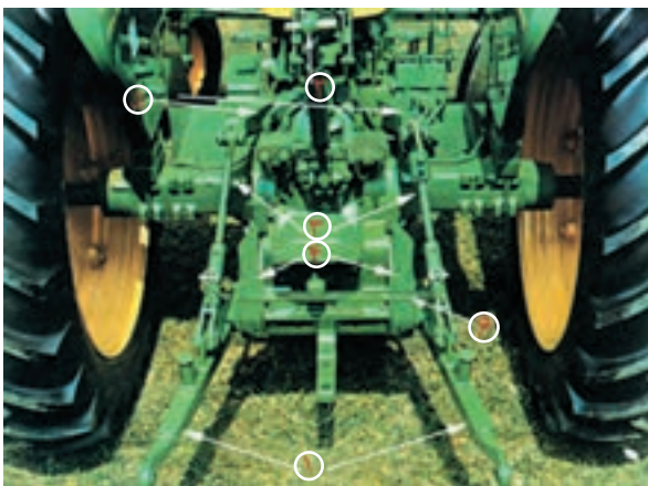
شکل ۳-۳- اجزای اتصال سه نقطه (در تراکتور JD ۳۱۴۰)
