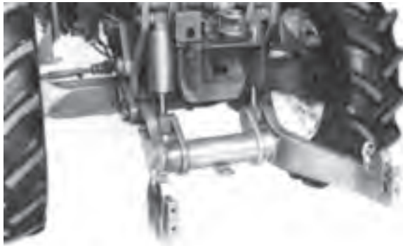
شکل ۲-۳- اتصال سه نقطه جلو (در تراکتور JD ۳۳۵۰)
