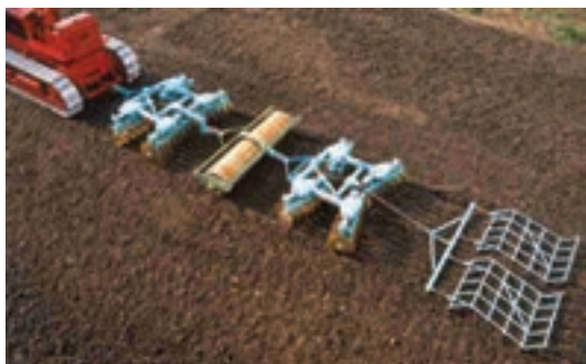
شکل ۵-۱۱- عملیات توأم خاک ورزی با چندین ماشین متصل به هم
