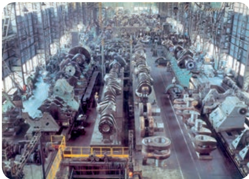
در این کارخانه اجزای میل لنگ کشتی روی هم منطبق می‌شوند.
