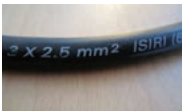
شکل ۲۷-۳ یک نمونه کابل NYY.
