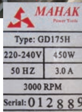
شکل ۴-۵۷ پلاک مشخصات موتور الکتریکی یک نمونه سنگ
