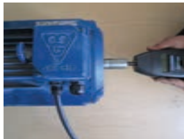
شکل ۴-۲۳ الف نحوه اندازه‌گیری مکانیکی سرعت موتور.
