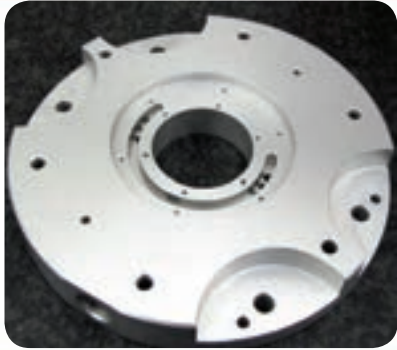
در این تصویر به حفره‌ها، سوراخ‌ها و رزوه‌های ایجاد شده روی سطوح قطعه توجه کنید.
