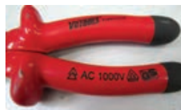
(الف) دسته عایق انبردست (در برابر ۱۰۰۰ ولت)
