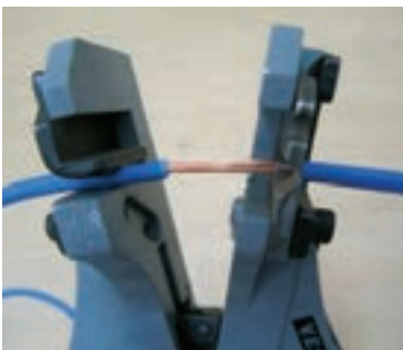
شکل ۳-۸ مراحل لخت کردن سیم توسط سیم‌لخت‌کن اتوماتیک.
