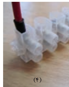
شکل ۳-۲۱ پرس کردن سرسیم.
