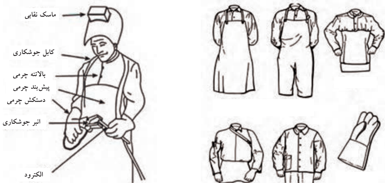
آماده شدن برای جوشکاری بالاسر
