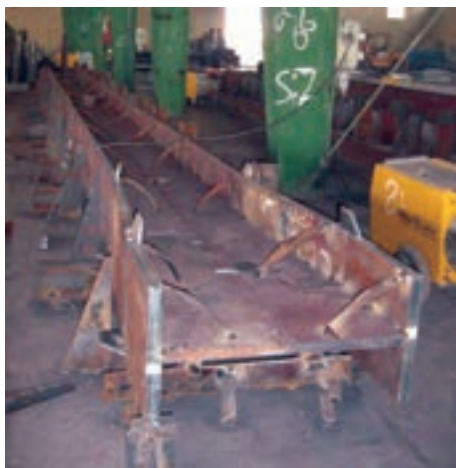
مونتاژ تیوروق با تغییر مقطع در قالب
