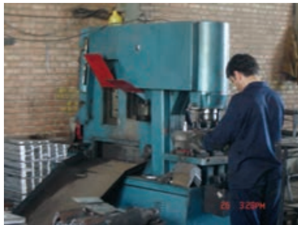
ب- دستگاه برش پروفیل‌های سبک (نیشی و ناودانی) و پانچ
