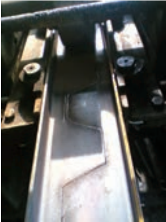
الف- برش غلتکی تیرهای لانه‌زنبوری
