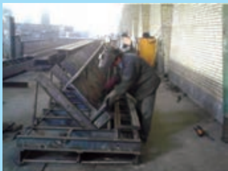
جوش طولی به روش زیرپودی
