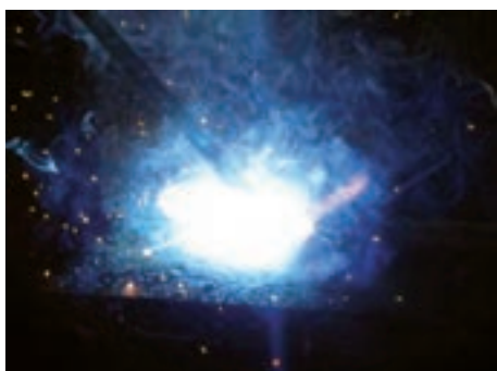
قوس الکتریکی در جوشکاری با الکتروود روکش‌دار
