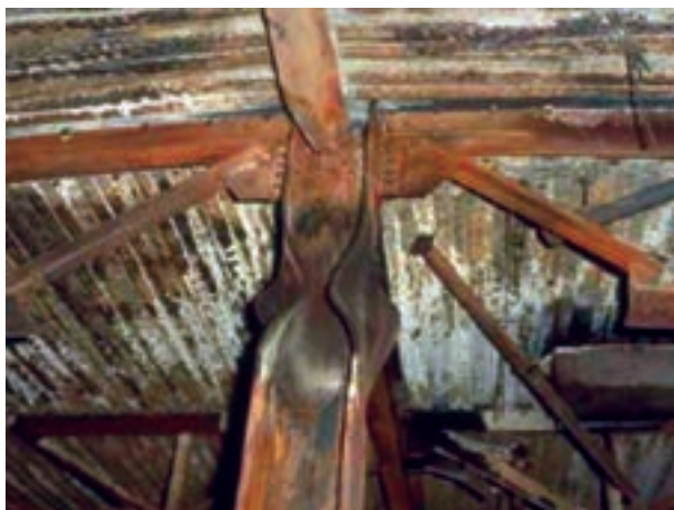
شکل ۴-۵- کمانش موضعی ستون
