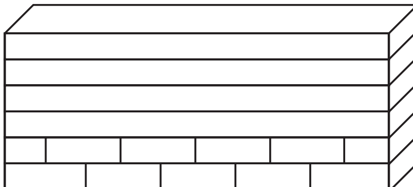
شکل ۴۷-۱- (چیدن دیوار نیم آجره در هشت ردیف با ملات)
