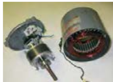
شکل ۷- موتور القایی تک فاز فاز شکسته
