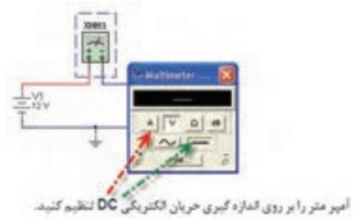
شکل ۶-۱۴ - تنظیم آمپر متر روی حالت DC
