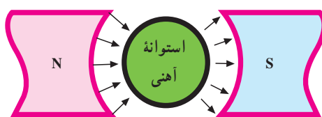
شکل ۳-۵ - چگونگی ایجاد میدان مغناطیسی یکنواخت و شعاعی
