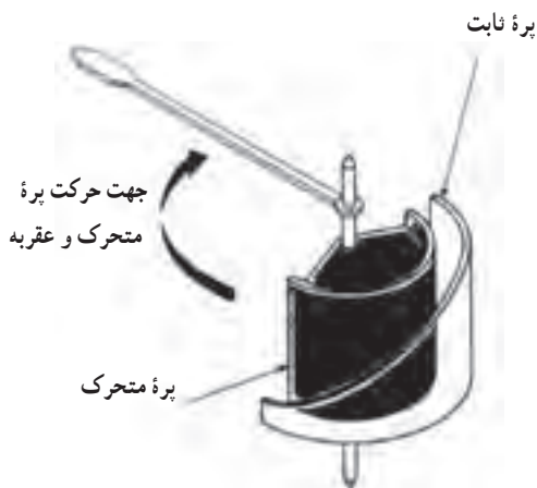
شکل ۵-۳۰- پره ثابت از یک شیب برخوردار است تا یک میدان غیر یکنواخت بین دو پره به وجود آورد.
