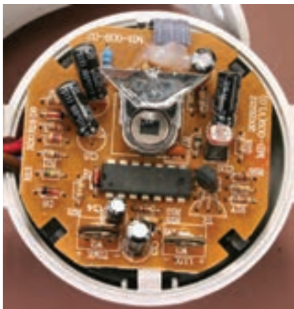
شکل ۵-۴۲ اجزای داخلی (PIR)
