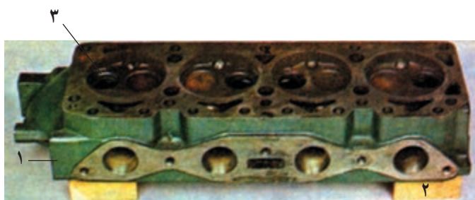
۱- سرسیلندر ۲- قطعه چوب ۳- نشیمنگاه شکل ۱۵-۸
