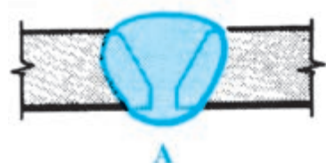
الف — اتصال لب به لب تخت با ریشه بسته
