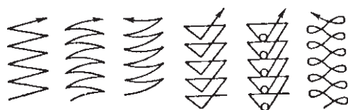
شکل ۳-۳۲- حالت های مختلف حرکت نوسانی نوک الکتروود
