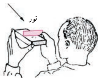
شکل ۱-۲۳- کنترل زاویه قائمه با گونیا
