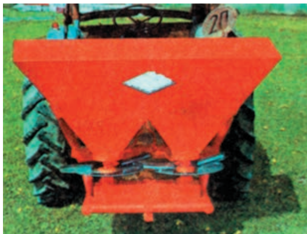
شکل ۱-۲- بذریاش سانتریفوژ با دو صفحه پرتاب کننده
