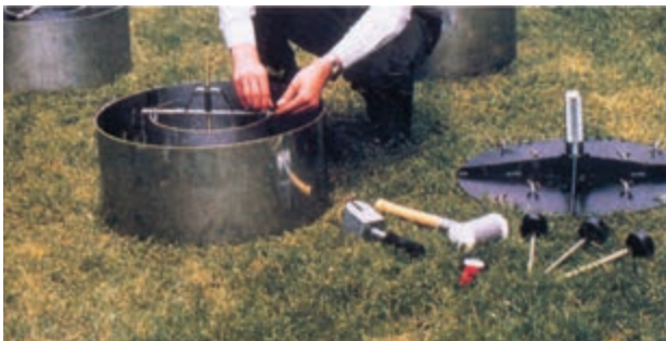
شکل ۳۰-۱ نحوه کار گذاشتن استوانه مضاعف
