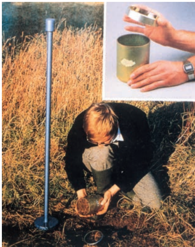
شکل ۱۶- ۱ نمونه برداری از خاک با سیلندر
