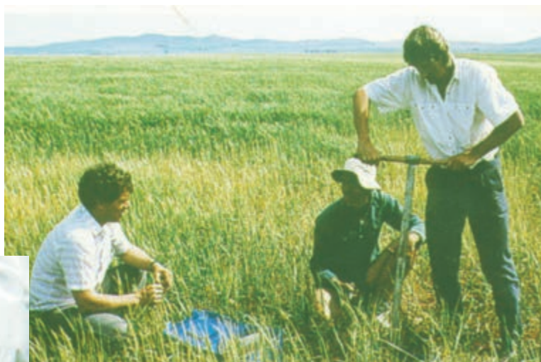
شکل ۱۳-۱ نحوه کار با اوگر
