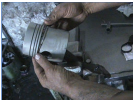
شکل ۱۳۸-۴ جازدن رینگ با دست
