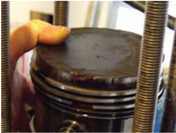
شکل ۴-۲۷- رسوبات کربن روی سطح پیستون
