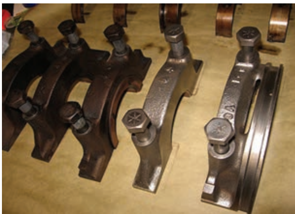
شکل ۱۵۴-۴- چیدن کپه یاتاقان‌ها
