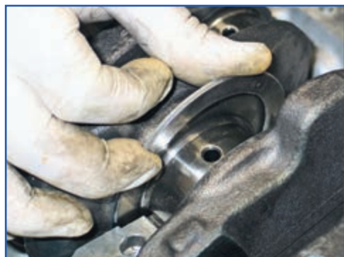
شکل ۱۸۴-۴ جازدن بغل یاتاقانی
