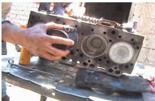
شکل ۱۹۹-۴- چسباندن رینگ جمع کن به سیلندر
