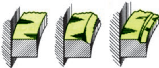
شکل ۱۳۲-۴- فرم خاص در لبه داخلی رینگ
