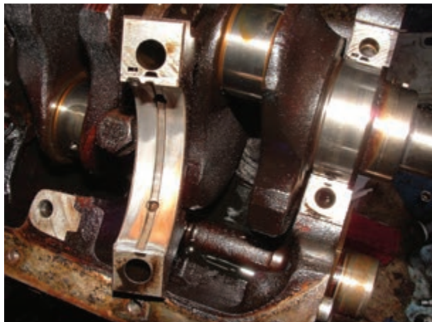
شکل ۱۸۲-۴ باز کردن کپه یاتاقان ثابت
