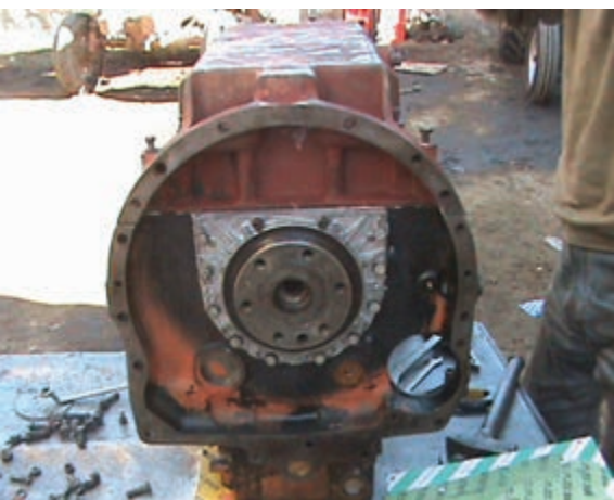
شکل ۱۵۰-۴ انتهای میل لنگ بدون چرخ لنگر
