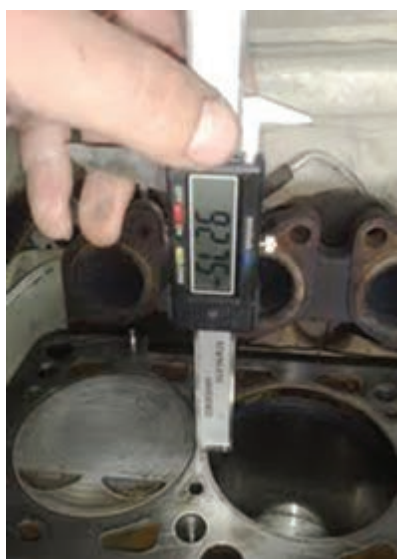
شکل ۱۴۵-۴- اندازه گیری بیرون زدگی بوش از روی سیلندر
