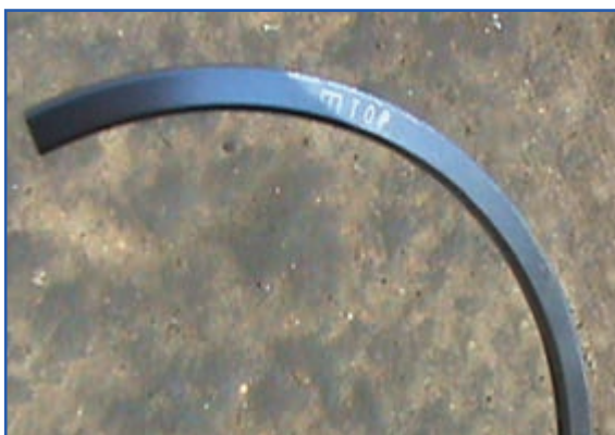
شکل ۱۳۴-۴- علامت TOP روی رینگ
