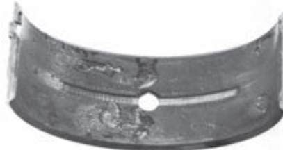
شکل ۱۶۷-۴ نقاط ذوب‌شده روی یاتاقان
