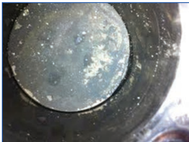
شکل ۲۰۶-۴ رسوبات کربن روی سطح پیستون
