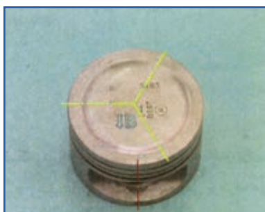
شکل ۱۳۵-۴ زاویه قرار گرفتن رینگ‌ها نسبت به هم
