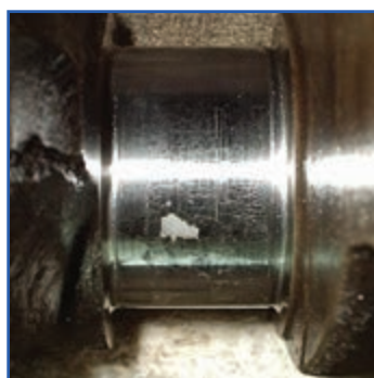
ب) پوسته کردن لایه سخت لنگ
