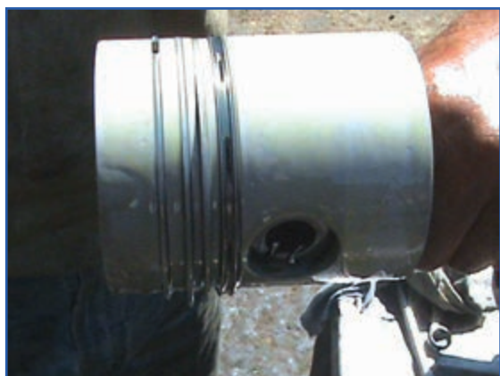
شکل ۱۴۰-۴ روغن‌کاری همه رینگ‌ها و پیستون
