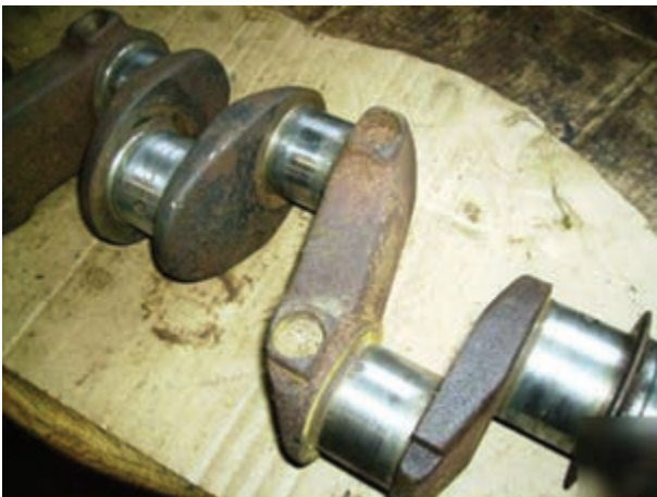
شکل ۴-۳۰- میل لنگ با رسوبات کربن
