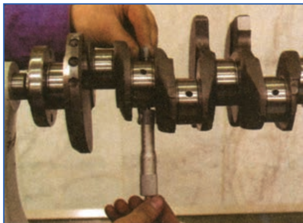
شکل ۱۶۲-۴ اندازه گیری قطر محورها میل لنگ
