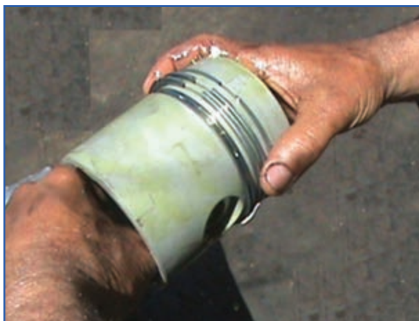
شکل ۱۹۶-۴- تنظیم کردن دهانه رینگ‌ها
