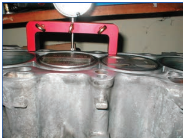
شکل ۲۰۵-۴ کنترل ارتفاع پیستون
