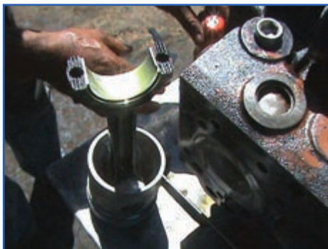
شکل ۱۹۲-۴ روغن‌کاری رینگ‌ها، پیستون و یاتاقان
