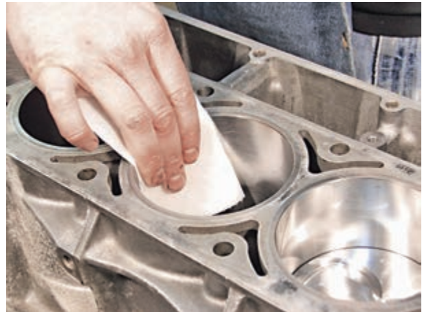
شکل ۴-۲۸- تمیز کردن داخل سیلندر
