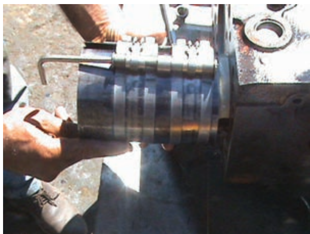
شکل ۱۹۸-۴- جمع کردن رینگ‌ها با رینگ جمع کن
