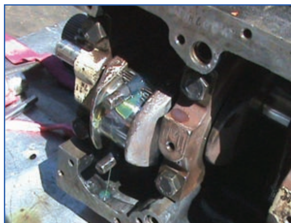
شکل ۲۰۳-۴ جا زدن شاتون روی میل لنگ
