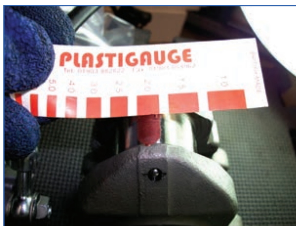
شکل ۱۷۶-۴ اندازه گیری دو بهنی پلاستی گیج شابلون
