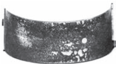
شکل ۱۶۸-۴ اثرات سوختگی روی یاتاقان
