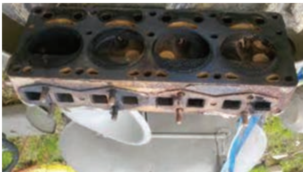
شکل ۴-۲۹- رسوبات کربن سطح سرسیلندر
