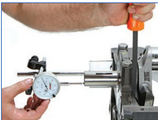
شکل ۱۷۹-۴ اندازه گیری لقی طولی میل لنگ با ساعت اندازه گیری
