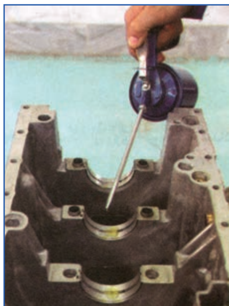
شکل ۱۸۷-۴ روغن کاری یاتاقان‌های ثابت
