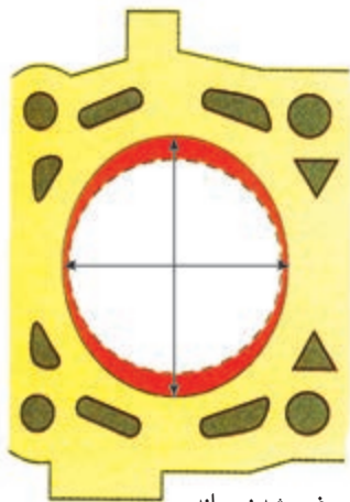
شکل ۱۴۹-۴ وضعیت بیضی شدن سیلندر
