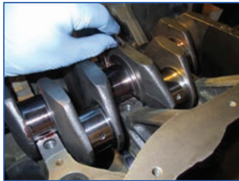
شکل ۱۸۳-۴ خارج کردن بغل یاتاقانی
