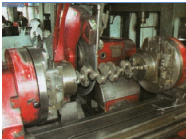
شکل ۱۶۴-۴ دستگاه میل لنگ تراشی
