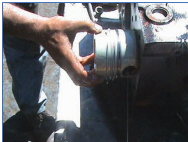
شکل ۱۹۷-۴- قرار دادن پیستون در سیلندر
