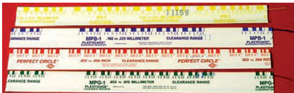
شکل ۱۷۸-۴ انواع پلاستیک گیج
