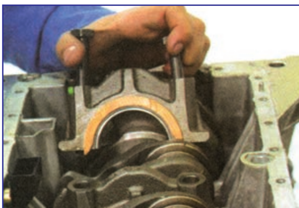
شکل ۱۸۱-۴ برداشتن کپه یاتاقان دارای بغل یاتاقانی
