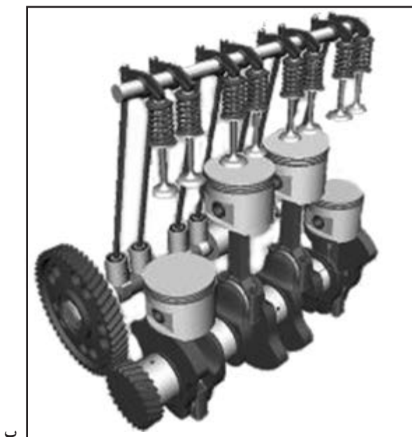
شکل ۸-۲ — قطعات مکانیزم باز و بسته شدن سوپاپ‌ها
