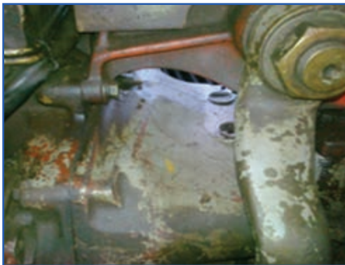
شکل ۹-۳- پیچ‌های اتصال موتور به جعبه‌دنده قسمت بالا
