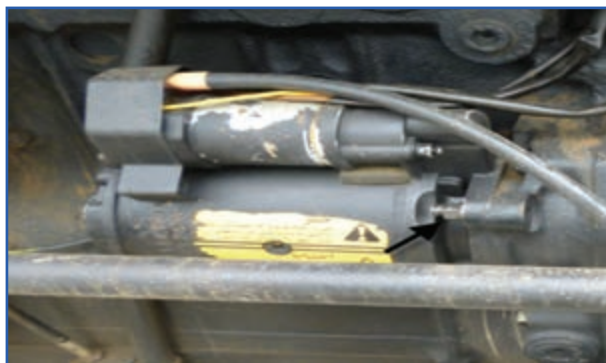
شکل ۳-۸ پیچ های نگهدارنده استارت تر تراکتور MF285
