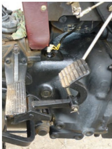
شکل ۱۱-۳ پیچ‌های اتصال موتور به جعبه‌دنده قسمت پایین
