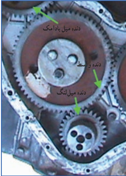
شکل ۱۲-۲- نسبت دنده میل بادامک به میل لنگ
