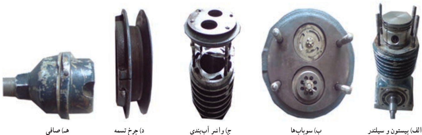
شکل ۳-۸- اجزای کمپرسور باد
