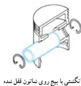
شکل ۳۱-۲- انواع اتصال انگشتی به پیستون
