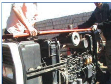
ج) برداشتن پوشش بالای موتور
