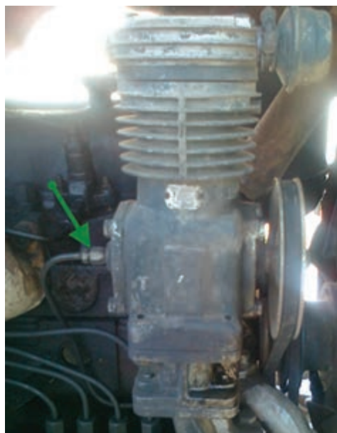
شکل ۵-۸- لوله روغن کاری کمپرسور در تراکتور U650
