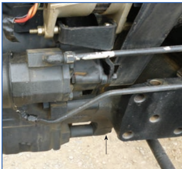
شکل ۱۷-۳- محل پیچ‌های اتصال موتور به جلوی تراکتور
