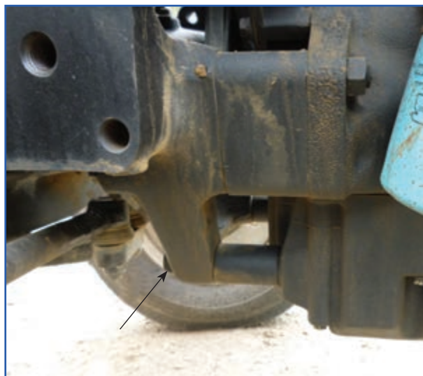
شکل ۱۷-۳- محل پیچ‌های اتصال موتور به جلوی تراکتور
