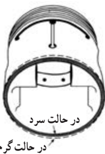
شکل ۱۹-۲ وضعیت پیستون در حالت گرم و سرد
