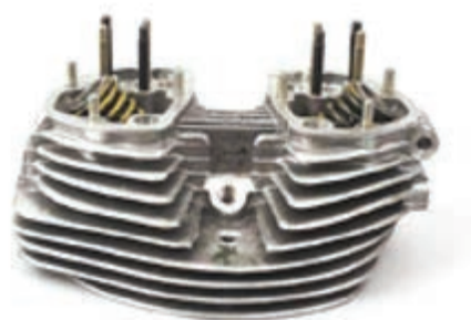
شکل ۳-۲ - سرسیلندر موتور هوا خنک
