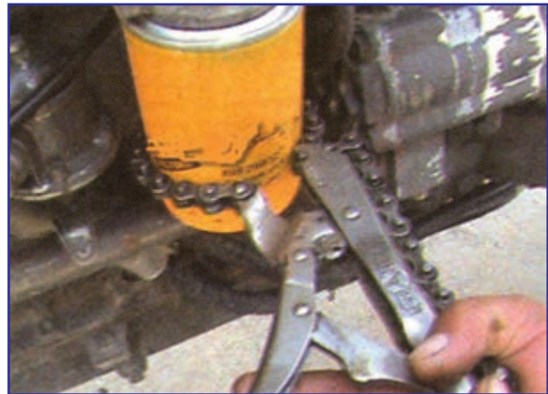
شکل ۱۶-۷ باز کردن صافی روغن با آچار مخصوص
