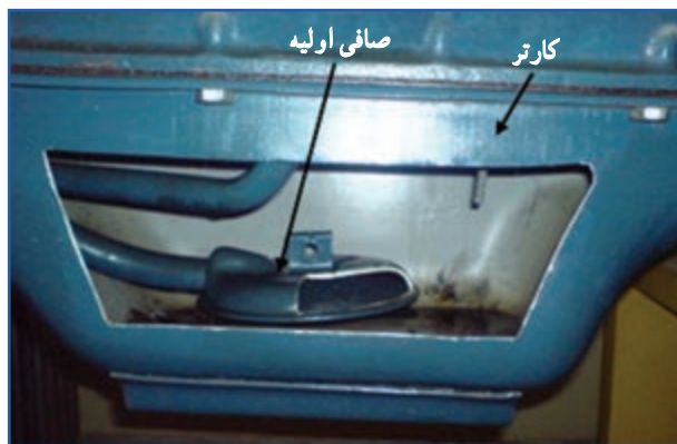
شکل ۲۴-۷- کارتیر برش خورده تراکتور U650
