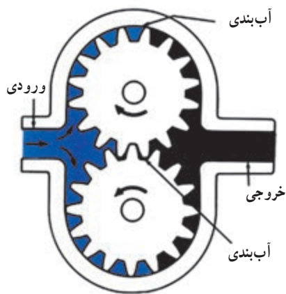
شکل ۱۹-۷- پمپ روغن چرخ دنده‌ای
