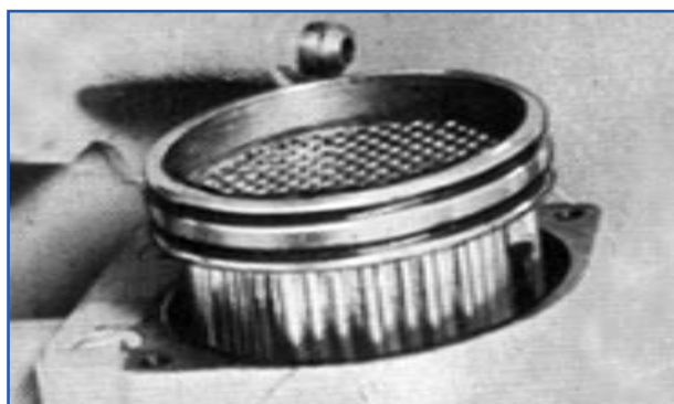
شکل ۳۵-۷- محل قرار گرفتن کویل روغن
