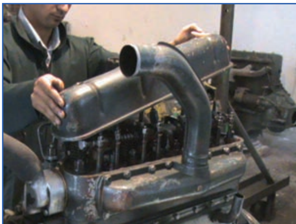
شکل ۴۰-۷ برداشتن قالباق سوپاپ
