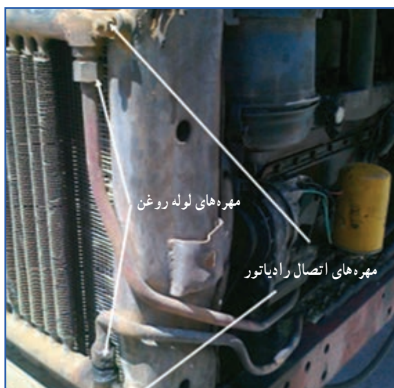
شکل ۳۸- ۷- مهره های لوله روغن سمت رادیاتور روغن
