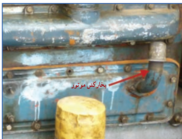
شکل ۲۶-۷- تهویه محفظه کارتیر تراکتور U650M
