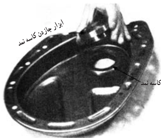
شکل ۴۳-۷- نحوه جازدن کاسه نمد روی سینی جلو
