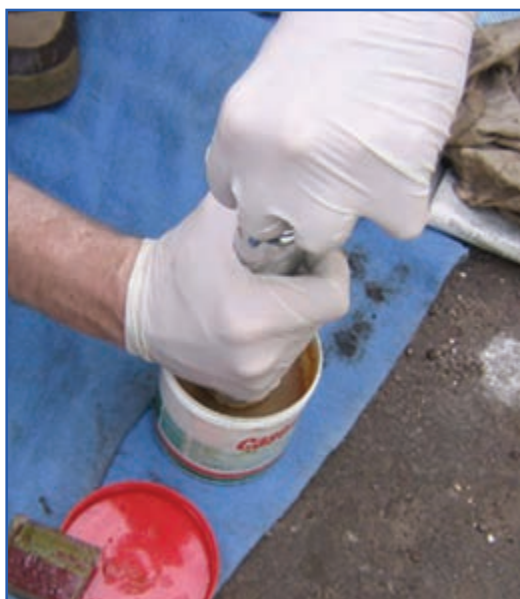
شکل ۴۸- ۷- مراحل پر کردن گریس پمپ دستی
