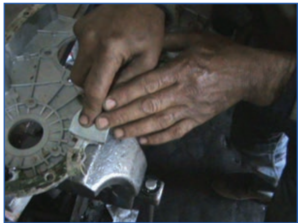
شکل ۴۱-۷ تمیز کردن واشر سینی جلو با کاردک
