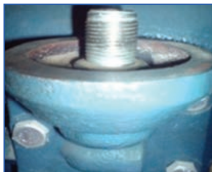
شکل ۱۷-۷ پایه صافی روغن تراکتور U650M
