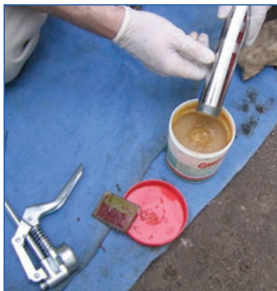
شکل ۴۸- ۷- مراحل پر کردن گریس پمپ دستی
