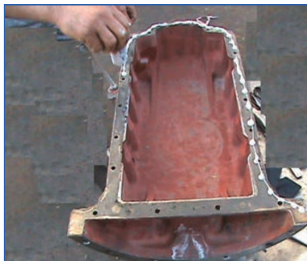
شکل ۳۲-۷ چسب زدن به محل قرارگیری واشر کارتر
