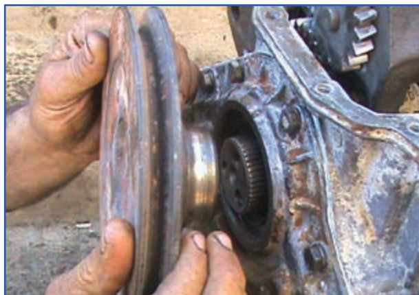
شکل ۴۶-۷- جازدن چرخ تسمه سر میل لنگ
